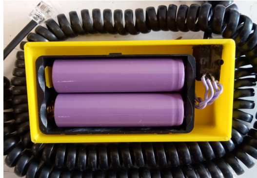
Figura 7: Baterías de alimentación.
