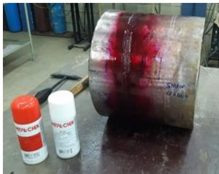
Figura 4: Ensaio de líquido penetrante realizado no cordão de solda – processo SMAW
