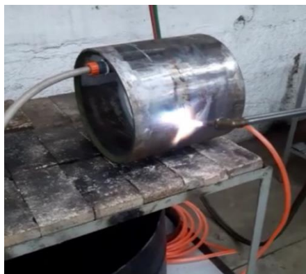
Figura 2: Taxa de resfriamento obtida com aquecimento em 3 pontos defasados 120° e passagem de fluido
