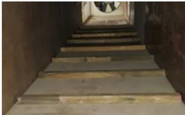
Figura 5. Ubicación de tacos para lograr el  $Z_0$  necesario dentro del túnel de viento.
