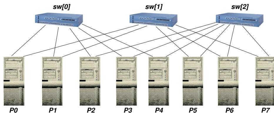
En el ejemplo de la figura tenemos 8 nodos conectados via 3 switches y puede verificarse que cualquier par de nodos está conectado en forma directa a través de al menos un switch. Para este ejemplo el vector  $sw$  sería
