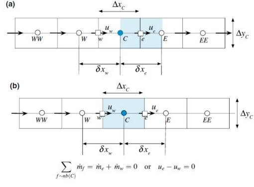
$a_e^u u_e + \sum_{f \sim NB(e)} a_f^u u_f = b_e^u - V_e (\nabla p)_e = b_e^u - V_e \frac{p_E - p_C}{\delta x_e}$
