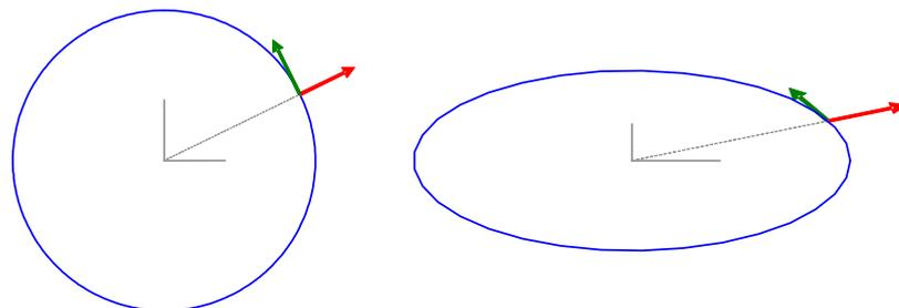
En una transformación afín, el vector normal transformado no es necesariamente normal a la superficie transformada, de hecho, podemos ver que eso solo sucede para las transformaciones de similaridad. El plano tangente sí se transforma en un plano tangente, porque la transformación afín conserva la combinación afín y así definimos el plano tangente.
