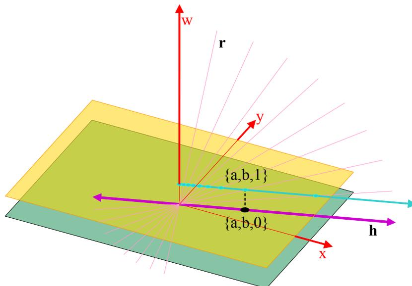
El punto  $\{a,b,1\}$  está justo por encima del  $\{a,b,0\}$  que define una recta  $h$  horizontal. La sucesión de puntos marcados en el plano proyectivo puede definirse mediante  $\{\alpha a, \alpha b, 1\}$ . Cuando  $\alpha$  crece, la recta
