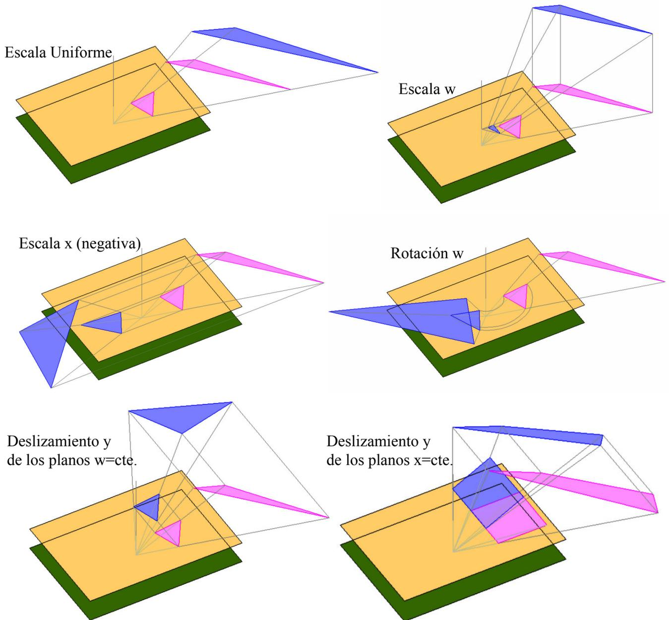
En **nuestro espacio:  $P^2$** , los casos simples son el escalado, el deslizamiento, la rotación y la traslación. Son las transformaciones afines, que ahora pueden ser representadas mediante una transformación lineal en un espacio de una dimensión más.
