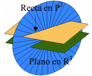
Dos rectas que se cortan en  $P^2$  en el punto  $Q$ , corresponden a dos planos que se cortan en la recta que pasa por el origen de  $R^3$  y por el punto  $Q$ . Dos rectas paralelas de  $P^2$  corresponden a dos planos por el origen de  $R^3$ , que se interceptan en una recta del plano  $w=0$ , paralela a ambas rectas de  $P^2$ . **En ambos casos se puede decir que la intersección existe; en el caso sencillo el punto  $Q$  tiene coordenadas finitas y en el otro es un punto ideal.**
