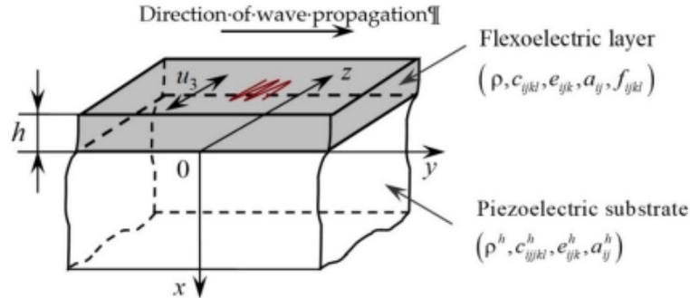
Figura 3: Estructura piezoeléctrica en capas (Hrytsyna et al., 2021)
