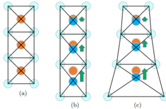
Figura 1: Origen del efecto flexo-eléctrico en sólidos. [Huang et al. \(2018\)](#)
