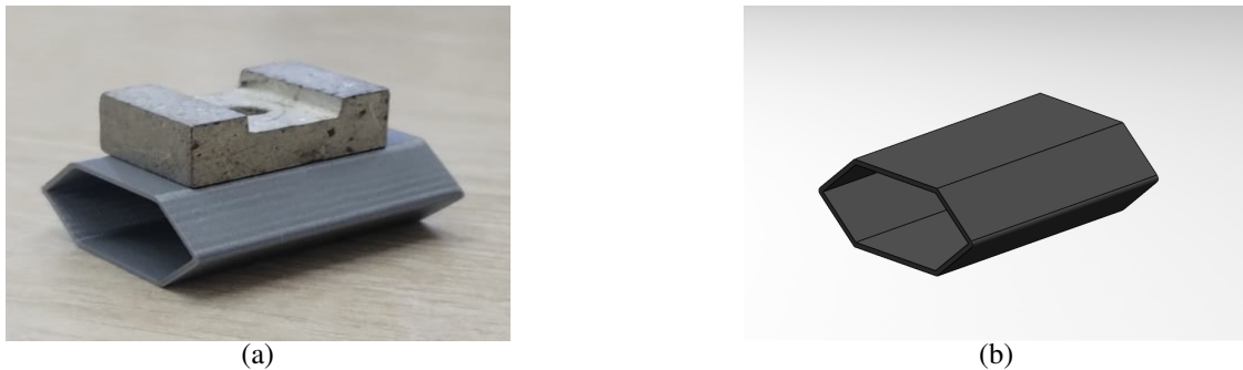
Figura 2: (a) Resonador Masa-Resorte.(b) Modelo CAD 3D del resorte romboidal.
