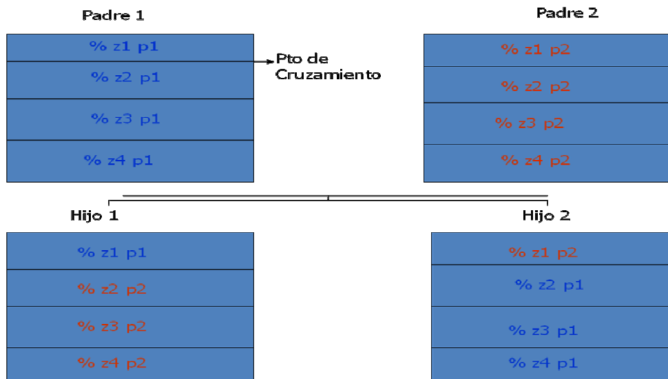
Figura 6. Esquema del operador cruce para el caso de distribución de agujeros por zonas
