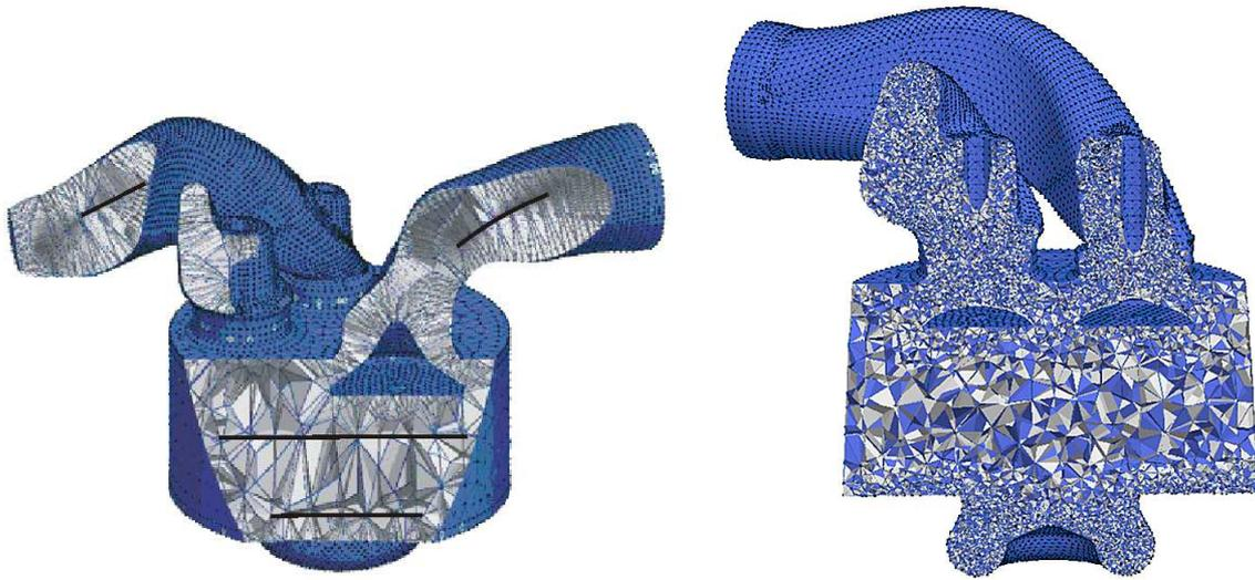
Figura 4: Mallas intermedia y final de una cámara de combustión.
