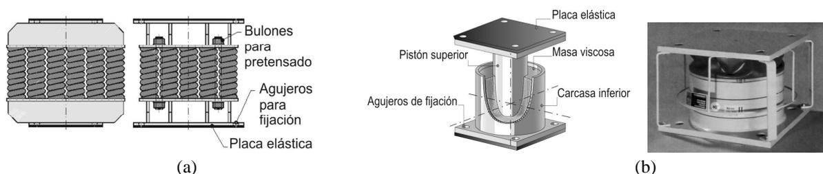
Figura 4: (a) Paquetes de resortes helicoidales metálicos (Gerb ®),
