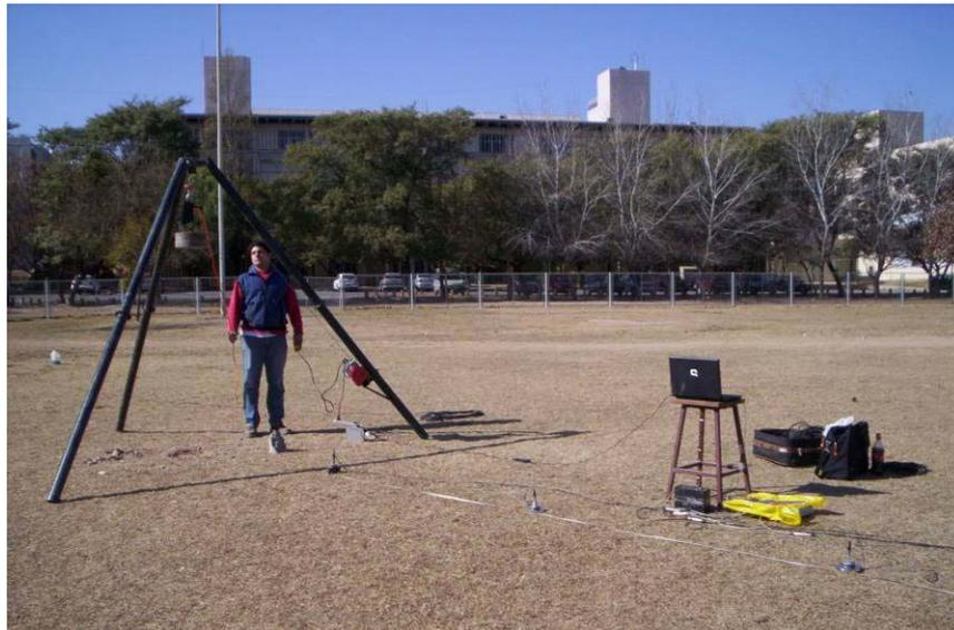
Figura 7. Aplicación de la carga impulsiva sobre la superficie del terreno.
