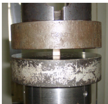
Figura 4. Ensayo de compresión a probeta hexaédrica.
