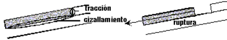
Figura 1: inicio de una avalancha de placa (corte)
