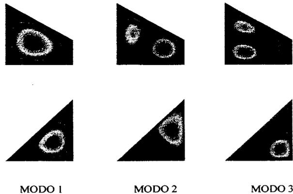
Figure 1: Formas modales de una membrana trapezoidal y triangular. Parámetros de frecuencias encontrados con MEC ( $M=N=13$ ) y entre paréntesis valores hallados con analogía de placas con MEF y 400 elementos. **Membrana trapezoidal** a) primer modo 5.6515 (5.6552), b) segundo modo 7.9541 (7.9660), c) tercer modo 9.3567 (9.3685). **Membrana triangular** a) primer modo 7.0250 (7.0318), b) segundo modo 9.9355 (9.9564), c) tercer modo 11.3282 (11.3521).
