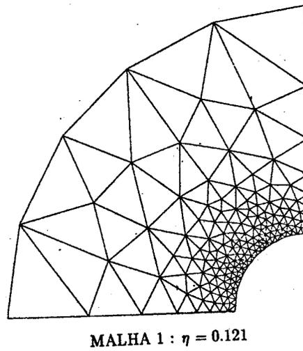
Neste terceiro exemplo se apresenta um semi-cilindro submetido a um carregamento distribuído na sua face superior e apoiado sobre uma superfície rígida. Neste exemplo foi necessário uma análise de contato utilizando elementos para estado plano de deformações (Fanello et.al, 1990). O erro solicitado foi de 8%.
