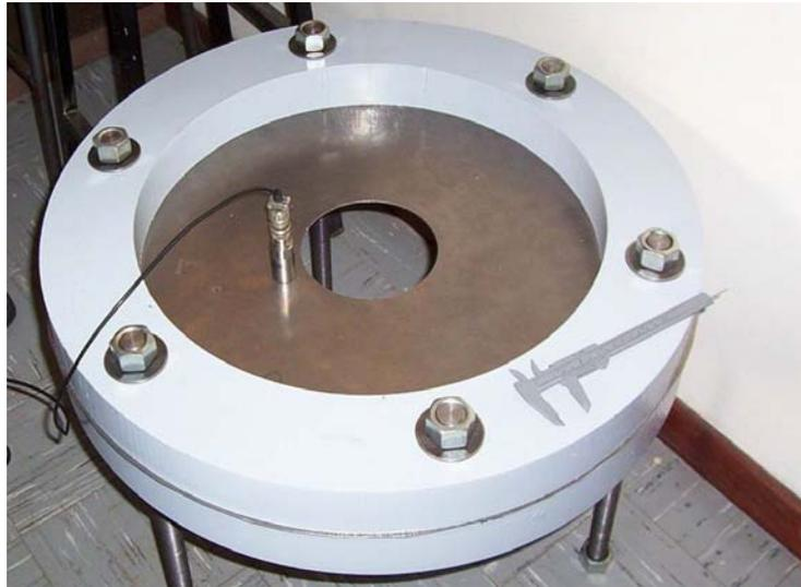
Figura 2: Placa empotrada en el borde exterior
