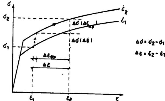
Figura 3. Visualização dos Incrementos de Tensão Devido à Plastificação e Viscosidade
