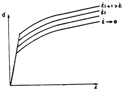
Figura 2. Curvas Tensão-Deformação Unidimensionais para Diferentes Taxas de Deformação
