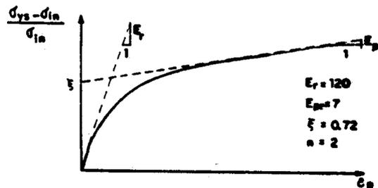
Figura 4. Curva Uniaxial de Referência para o Modelo com Endurecimento
