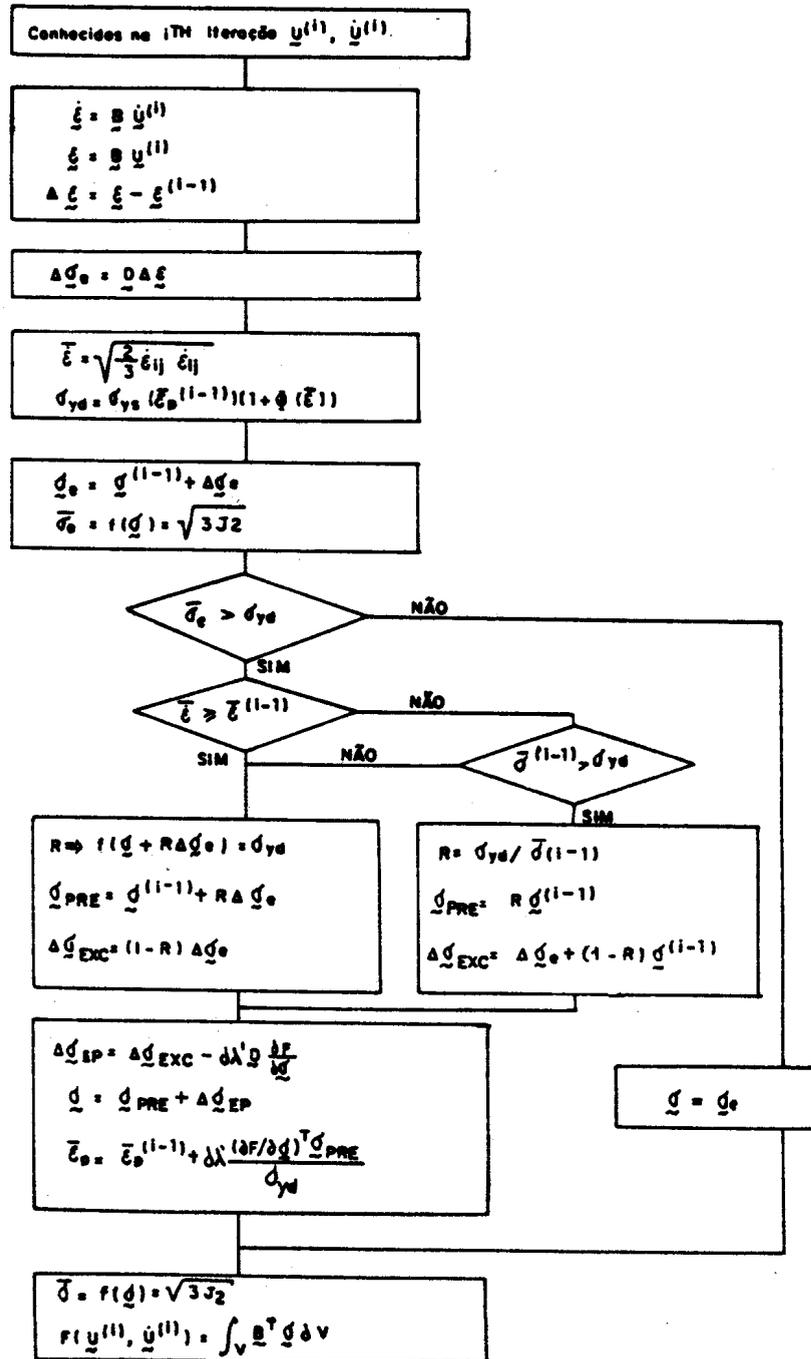
Fig. 6. Algoritmo para Cálculo das Forças Internas Resistentes
