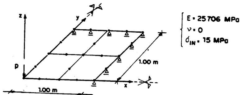
Figura 10. Estrutura e Discretização em Elementos Finitos
