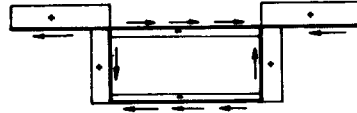
Fig. 6 Distribución del esfuerzo de corte de alabeo torsional en una sección sometida a un momento torsor positivo.
