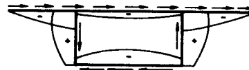
Fig. 10 Distribución del esfuerzo de corte de alabeo distorsional en una sección sometida a un momento torsor positivo.
