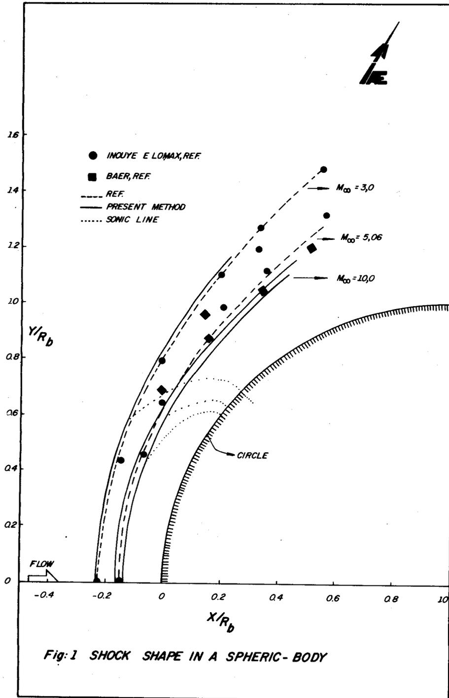
Fig:1 SHOCK SHAPE IN A SPHERIC-BODY
