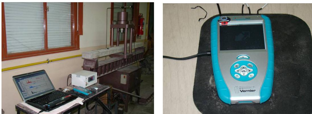
Figura 11: Instrumental utilizado para medición de las frecuencias naturales.
