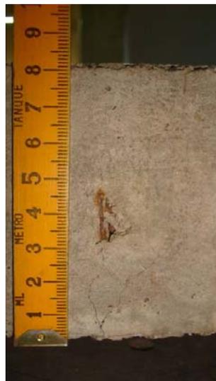
Figura 20: Modelo de viga ensayada con una fisura en el centro.
