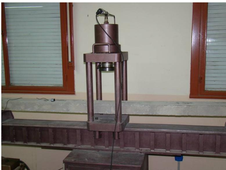
Figura 8: Modelo de una viga simplemente apoyada simulando una fisura en el centro
