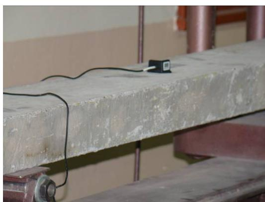
Figura 10: Acelerómetro conectado a  $\frac{1}{4}$  de la luz desde el apoyo.
