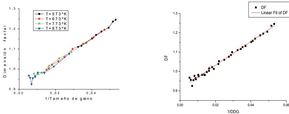
Figura 16. Dimensión fractal en función de la inversa del tamaño de grano para aluminio con 20 orientaciones
