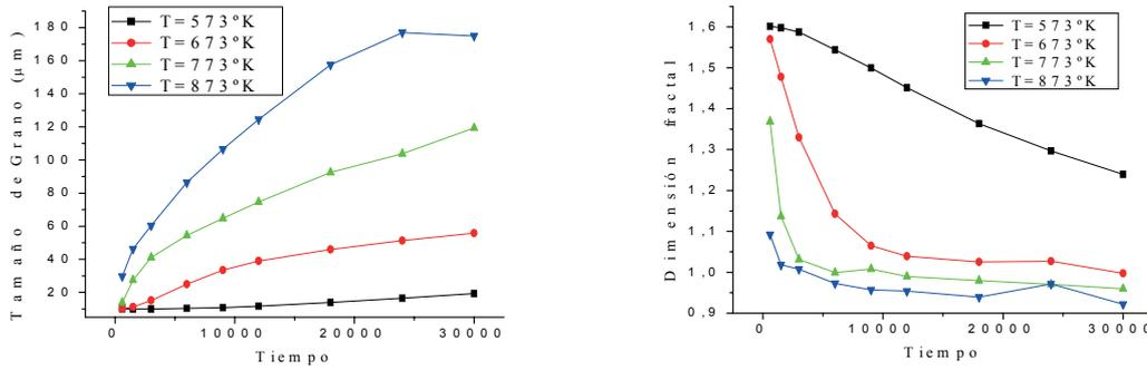
Figura 13. Variación del tamaño de grano y la dimensión fractal de la microestructura con el tiempo de simulación para diferentes temperaturas de ensayo. Aluminio 100 orientaciones
