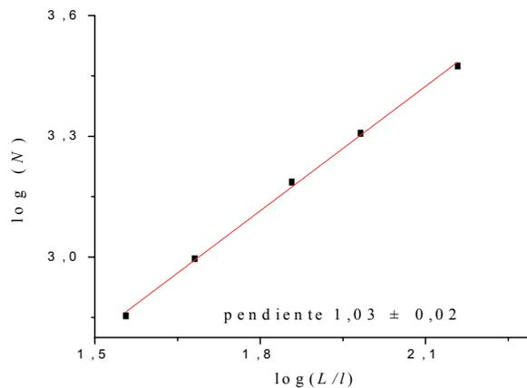
Figura 12. Curva de regresión correspondiente a la obtención de la dimensión fractal para la microestructura mencionada.
