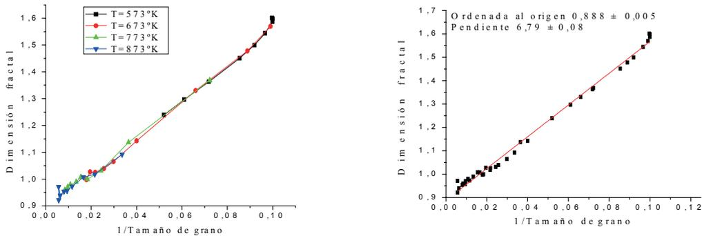
Figura 14. Dimensión fractal en función de la inversa del tamaño de grano para diferentes temperatura de ensayo
