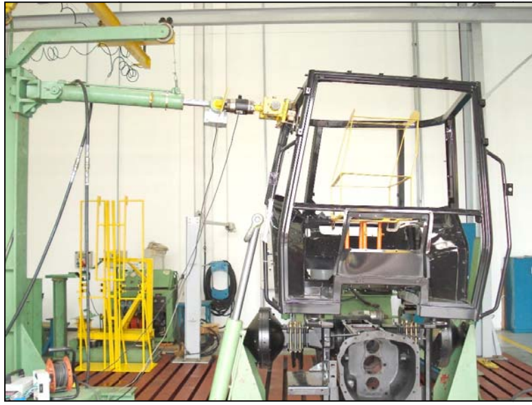
Figura 9: Ensaio de carregamento lateral.
