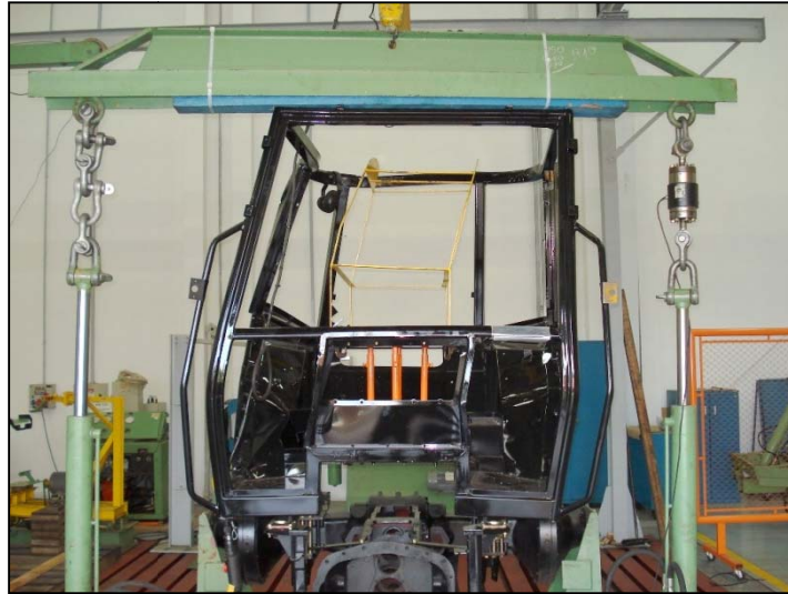
Figura 7: Ensaio de esmagamento das colunas dianteiras.
