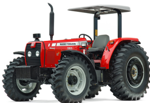
Figura 1: Trator Massey Ferguson plataforma com ROPS de dois postes.(AGCO do Brasil)
