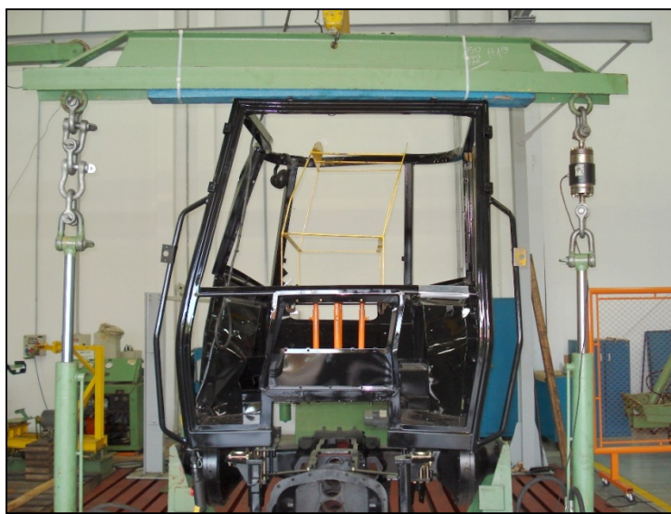
Figura 11: Ensaio de esmagamento das colunas dianteiras.
