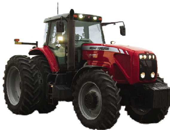
Figura 2: Trator Massey Ferguson cabinado com ROPS de seis postes. (AGCO do Brasil)
