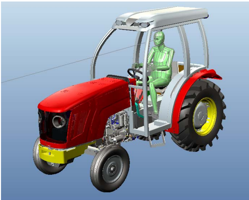
Figura 12: Imagem em perspectiva do lay-out do trator estreito com a cabina e o teto já montados.
