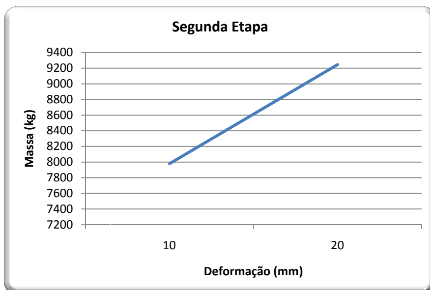
Figura 28: Curva da massa em relação à deformação na segunda etapa do teste.
