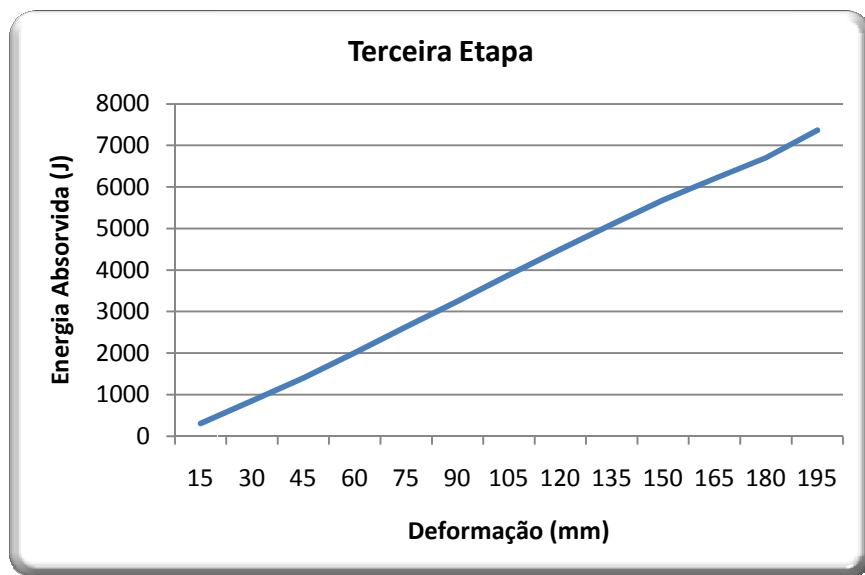
Figura 29: Curva da energia absorvida em relação à deformação na terceira etapa do teste.
