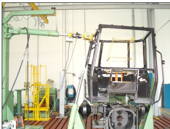
Figura 5: Ensaio de carregamento lateral.
