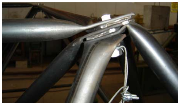
Figura 22: Formação de charneira plástica - LTE (Ponto 3 - 25kN)
