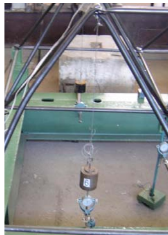
Figura 15: Instrumentação dos nós 5, 6, 7 e 8
