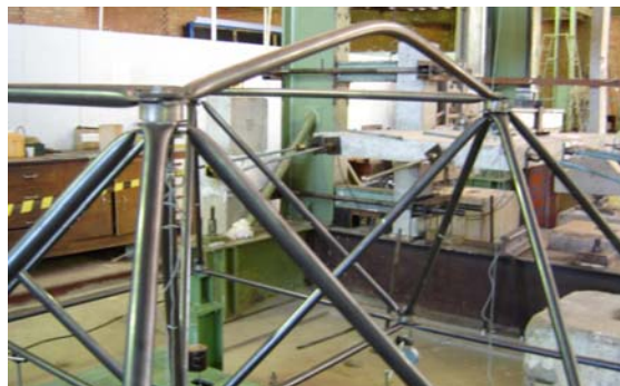
Figura 23: Colapso do elemento comprimido – LTDCE (Ponto 2 - 42kN)
