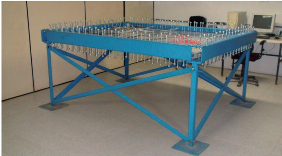
Figura 2 – Vista geral da estrutura de ensaio da placa de alumínio do LADEPIS.
