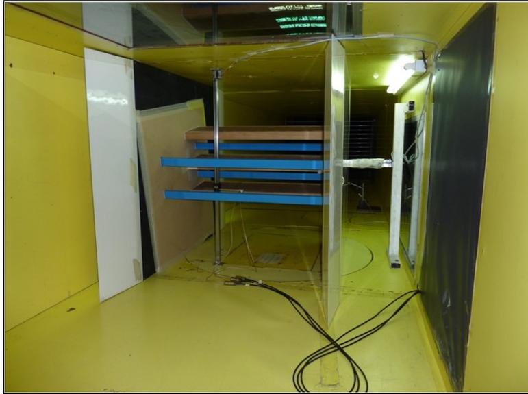
Figura 2: Maqueta instalada, balanza aerodinámica y poste-posicionador de punta de medición de velocidades. Se observan las placas laterales para mantener la bidimensionalidad del flujo medio.
