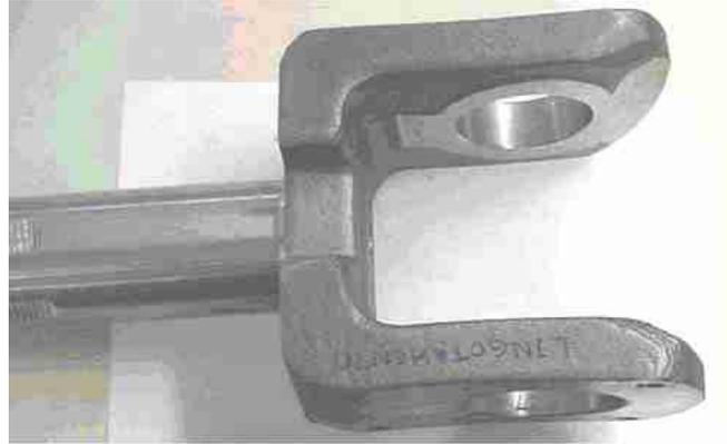
Figura 5: Deformação plástica do garfo após ensaio de tração
