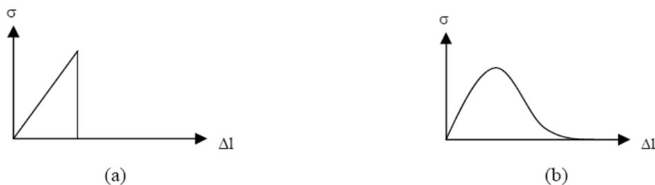
Figura 4- Comportamento do material em ensaio de ruptura sob deformação controlada: (a) material frágil (b) material dútil (Soares, 1997).
