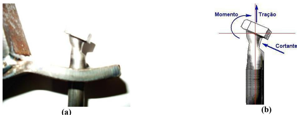
Figura 1 – a) Flange e parafuso com abertura de um dente; b) Esforços atuantes no parafuso.
