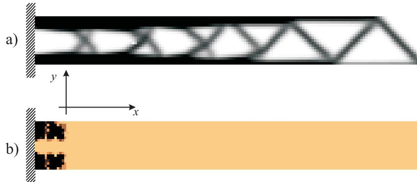
Figure 3: Optimal topologies ( $z$  free). a)  $\rho_1$  b)  $\rho_2$
