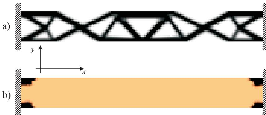
Figure 7: Optimal topologies ( $r_{min}^1 \neq r_{min}^2$ ). a)  $\rho_1$  b)  $\rho_2$
