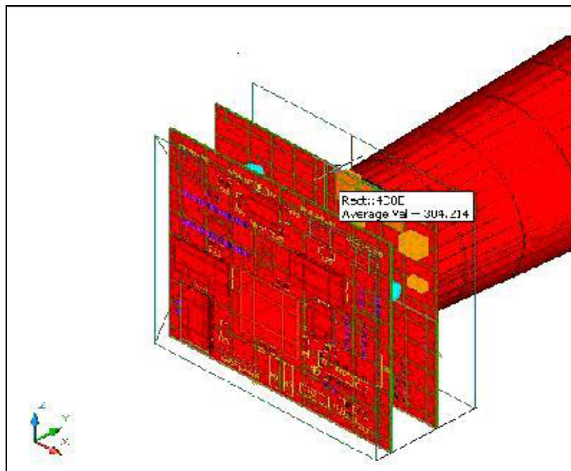
Figura 4. Modelo térmico del Star Tracker con óptica.
