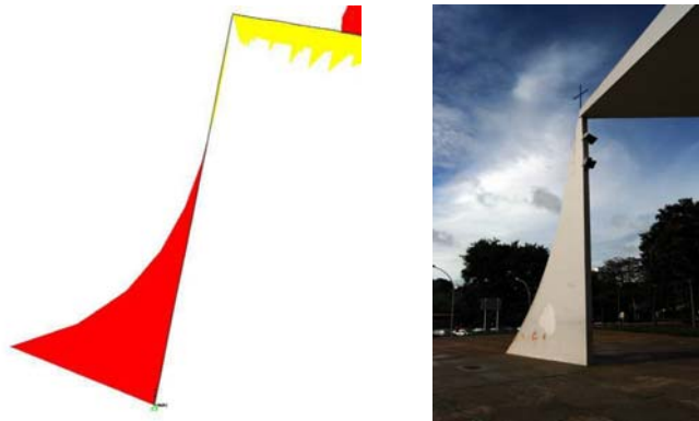
Figura 32: Diagrama de Momentos Fletores – detalhe do Pilar Frontal. Desenho do autor. Programa SAP 2000 e Pilar Frontal da Igrejinha Nossa Senhora de Fátima. Foto do autor..
