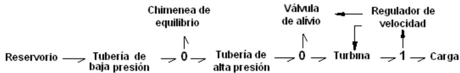
Figura 4: Representación de la central hidroeléctrica simplificada con BG en “palabras”
