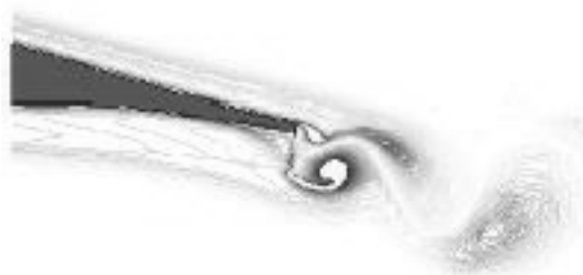
Figura 2. Esquema de las estructuras vorticosas contrarrotativas que se desprenden corriente abajo del mini-flap Gurney.
