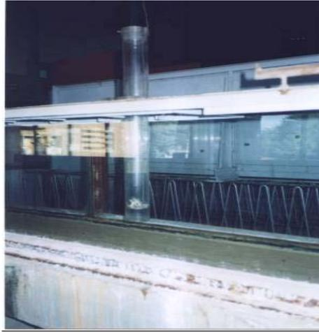
Fig.2: Canal de ensayo y modelo experimental de la camisa y bomba.
