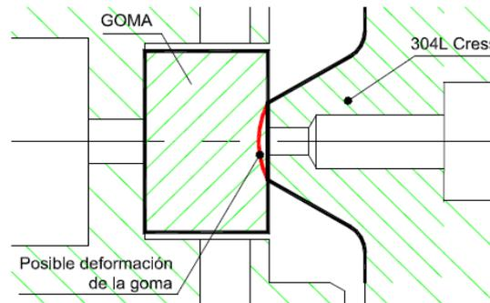
Figura 2: Detalle del cierre de la válvula.
