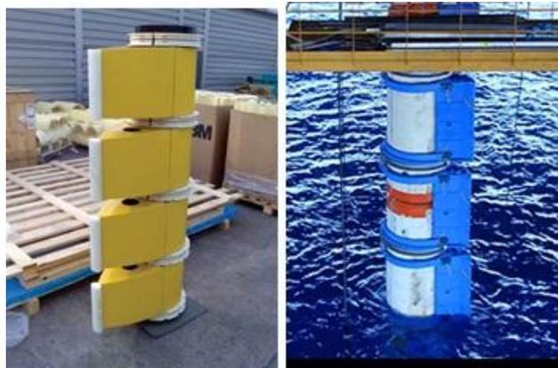
Figura 2: Riser com dispositivo tipo *Fairing* (fonte: vivsolutions.com)
