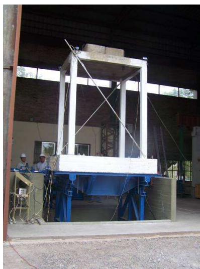
Figura 1: Pórtico de hormigón armado en la mesa vibradora de la Universidad Nacional de San Juan.
