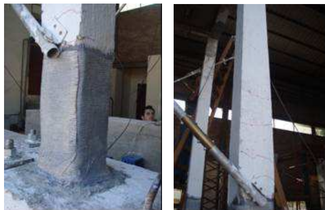
Figura 8-a: Fisuras en columnas del pórtico con refuerzo, luego de aplicar los 5 inputs dinámicos.
