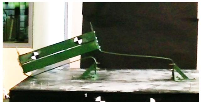
Figura 17: Configuración deformada final: a) modelo numérico b) modelo experimental
