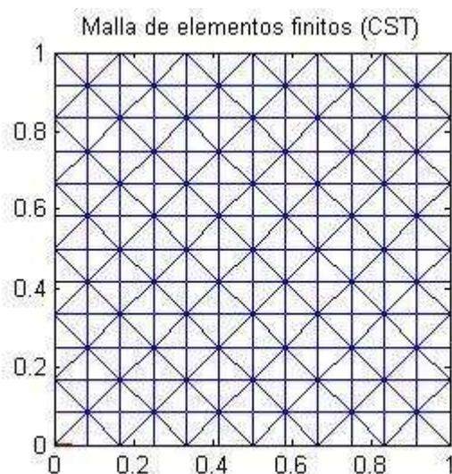
Figura 7 – Malla de elementos finitos sobre un dominio ejemplo.
