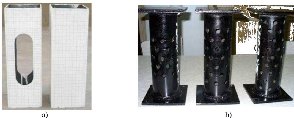
Figura 2: Disipadores Perforados. a) Cuadrados. b) Circulares
