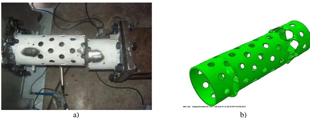
Figura 14: Prototipo circular perforado. a) Resultado experimental, b) Predicción analítica
