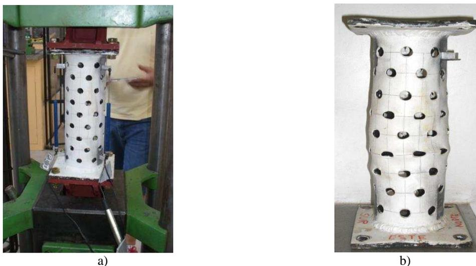
Figura 5: Prototipo circular perforado. a) Montaje e instrumentación previo al ensayo. b) Después del ensayo
