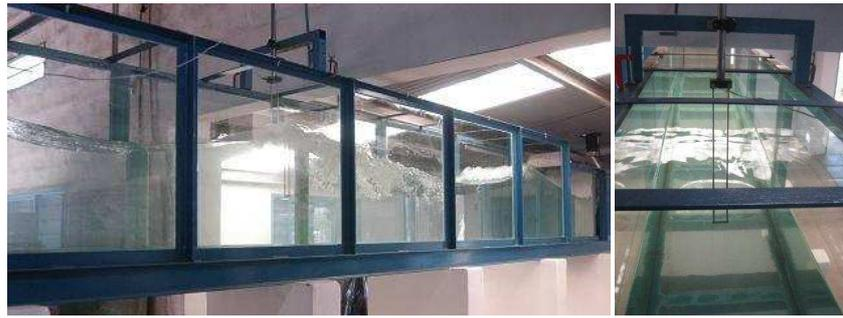
Figura 1. Canal de oleaje del LH (izquierda) y un sensor resistivo (derecha).
