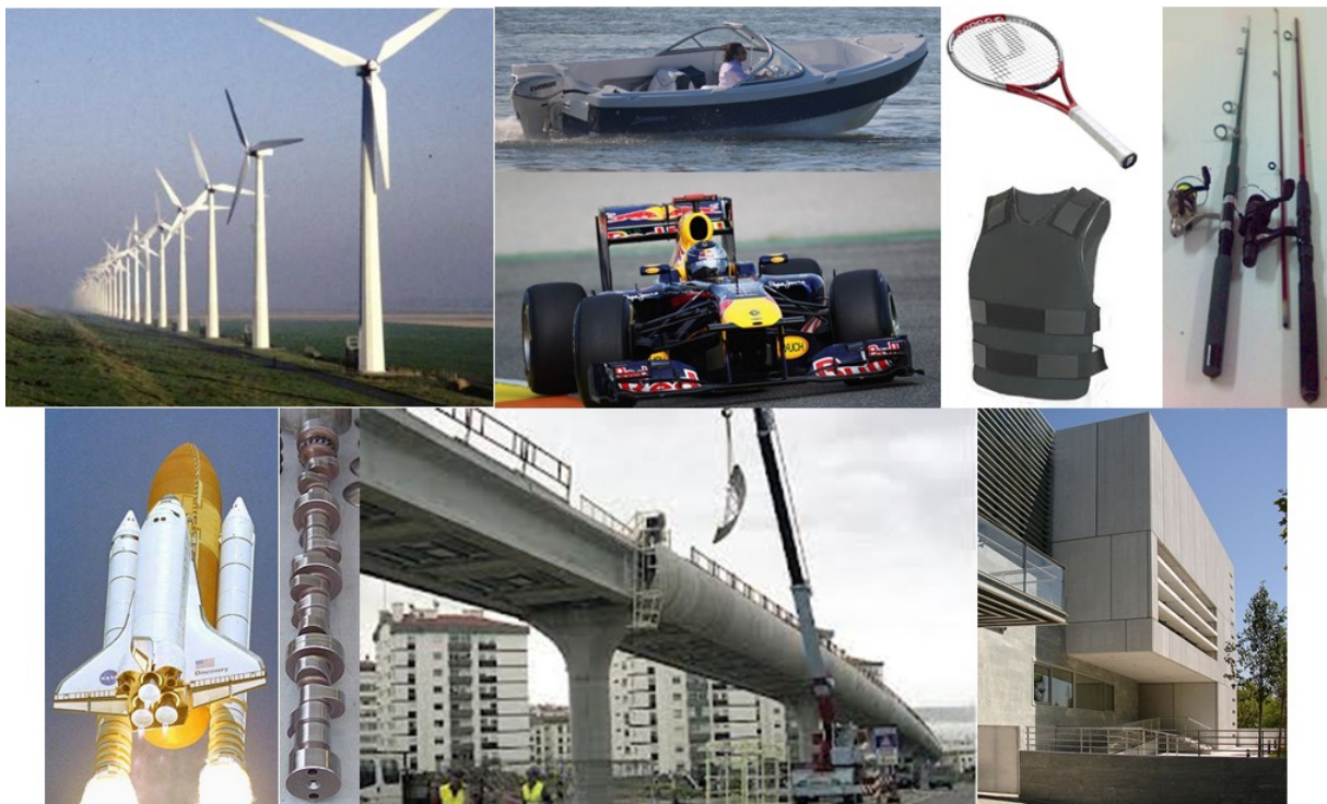
Figura 1: Algunos ejemplos sobre el empleo de materiales compuestos: Turbinas eólicas, automóviles, lanchas, raquetas, cañas de pescar (matriz polimérica con fibras de vidrio o carbono), Chalecos antibalas (matriz polimérica con fibras aramídicas), Puntales transbordador espacial (matriz metálica con fibras de boro), Árbol de levas (matriz metálica con fibras cerámicas), Parantes o paneles (matriz cerámica, hormigón, con fibras de vidrio), etc.
