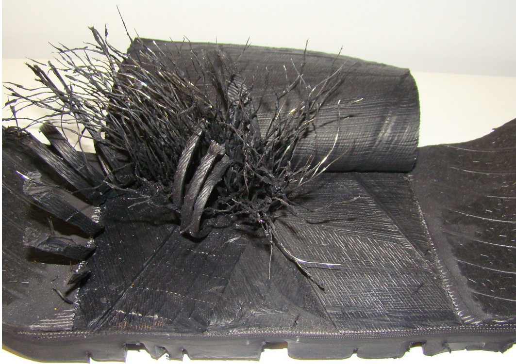
Figura 16: Sector de Cubierta Luego de la Inspección de las Cinturas de Acero
