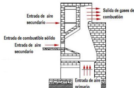
Figura 2. Aire primario y secundario en la geometría de la cámara
