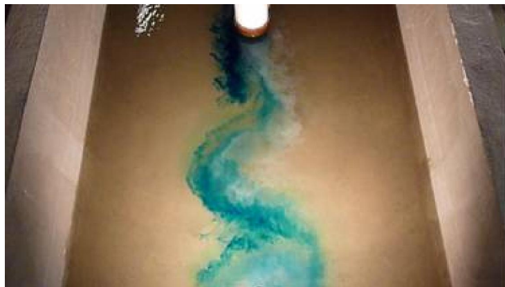
Figure 4.- Visualización del flujo en la interfase de mezcla aguas abajo de la confluencia de flujos paralelos.
