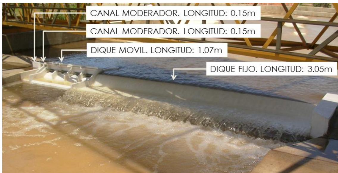
Figura 3: Representación de las estructuras de evacuación en el Modelo Físico Presa Los Molinos.
