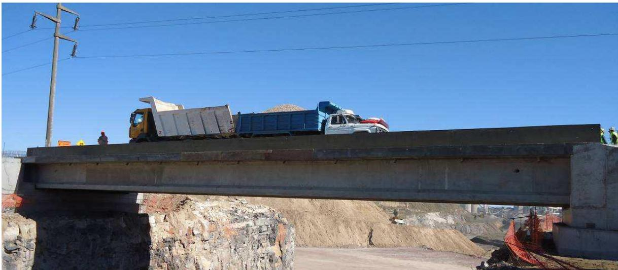
Figure 3: Instancia de la Prueba de Carga con 4 camiones
