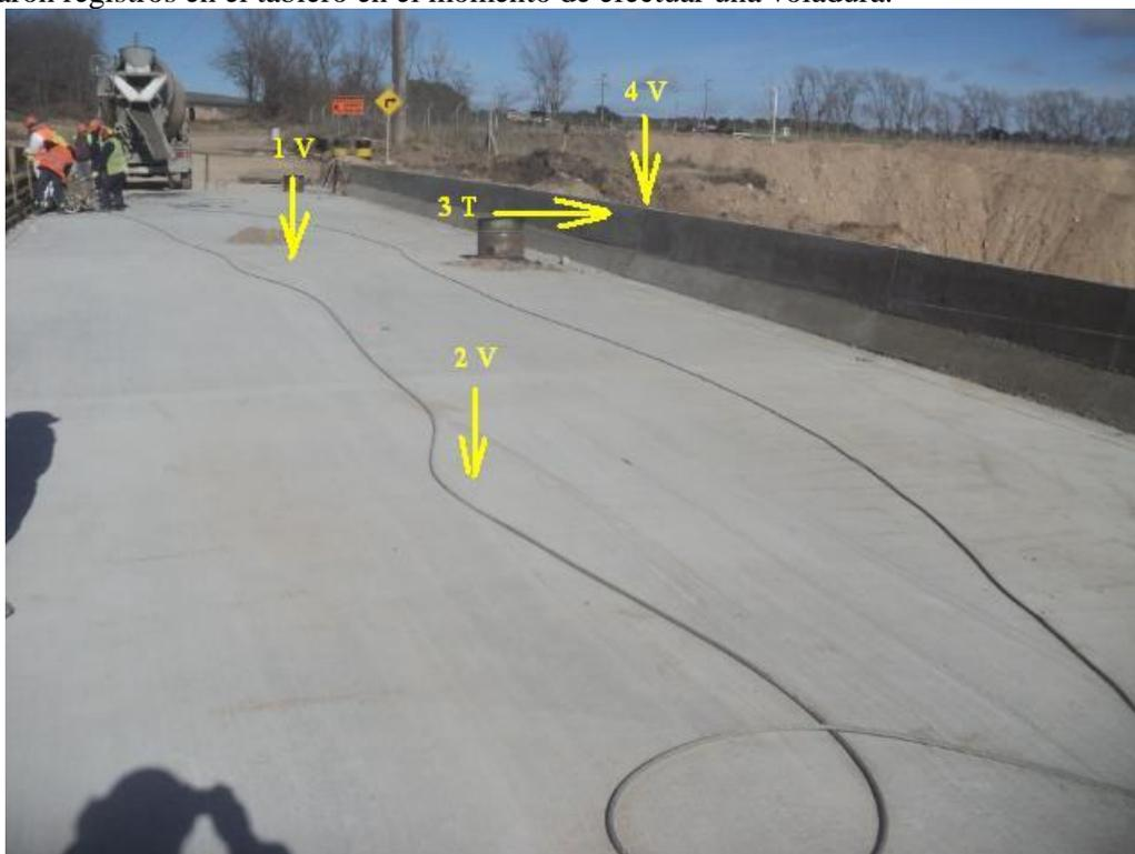
Figura 6: Ubicación de los sensores para la evaluación dinámica
