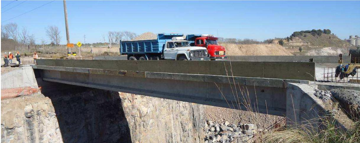
Figura 2: Instancia de la Prueba de carga con dos camiones
