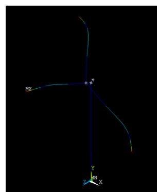
Figura 5: Segundo modo de flexión de las palas colectivo en la dirección del flap
