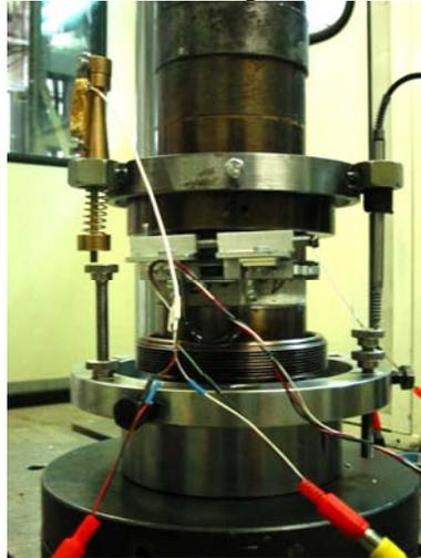
Figura 8. Disposición ensayo no confinado
