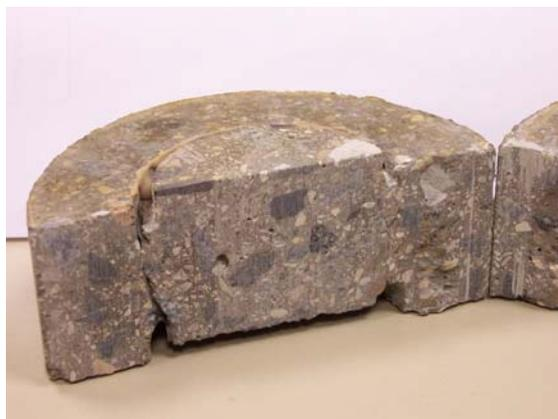
Figura 16. Plano de fractura en modo IIa.
