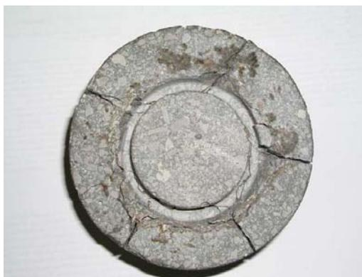
Figura 11. Fotografía de una muestra ensayada a corte sin confinamiento lateral.
